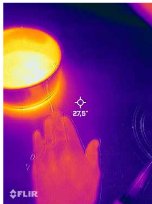
Lämpökamera kuvaa osoittaa, että induktioliesi lämpenee vain siltä alueelta, jossa on liedelle soveltuva metalliastia.
